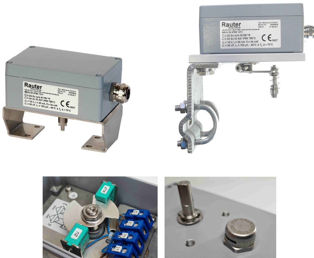
Bild 1-4: Aluminium-Tieftemperatur-Endschalterbox, Abm.: 125x80x57 mm für Dreh- und Linearantriebe mit 2x Pepperl+Fuchs Sensoren SJ 3,5-SN, Bild 4: Druckausgleichelement in Endschalterbox für Linearantriebe ohne Aluminiumplatte.
