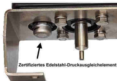
Bild 28+28a+28b: Ex i ... 8 V DC Polyamid-Endschalterbox, 2x P+F Sensoren SJ 3,5-S1N, mit im Gehäuseboden eingebautem Edelstahl-Druckausglichelement zur Verhinderung von Kondenswasserbildung
