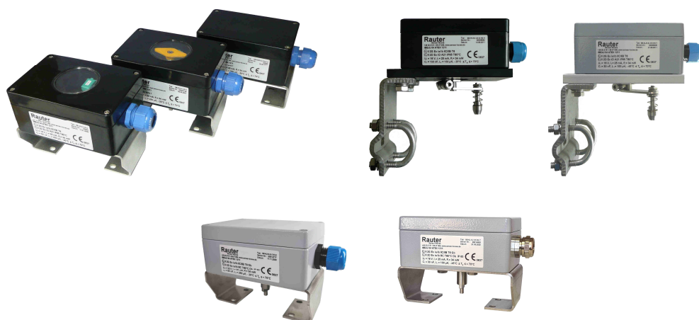
Bild 1-4+4a: Bild 1: Polyamid-Endschalterboxen (dieser Typ kann auch im Bergbau mit spezieller Ex-Kennzeichnung eingesetzt werden), 120x80x55 mm für Drehantriebe, Bild 2+3: Polyamid- und Aluminium-Endschalterboxen für Linearantriebe, 120/125x80x55/57 mm. Bild 4 +4a: Aluminium-Endschalterbox und Tieftemperatur-Endschalterbox für Drehantriebe, 125x80x57 mm
