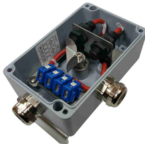
Bild 22a: Aluminium-Tieftemperatur-Endschalterbox mit 2x P+F Sensor NJ2-12GK-SN, Umgebungstemperaturbereich: -40\text{ °C} \leq T_a \leq +70\text{ °C}
