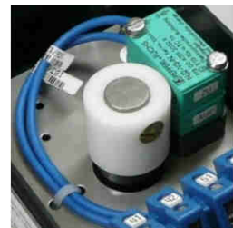
Bild 17-20: Bild 17+17a: Endschalterboxen im Aluminium-Gehäuse und verschiedene Innenansichten mit P+F Sensoren SJ 3,5-N und SJ 3,5-SN, Bild 18, NJ2-11GK-N, Bild 19, NJ2-V3-N, Bild 20
