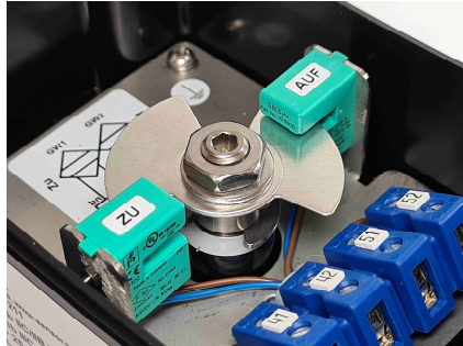
Bild 4+5: links: 2x Pepperl+Fuchs-Sensoren SJ 3,5-N für Position 0° und 90°. Die untere Schaltfahne wird mit einem Innensechskantschlüssel SW = 4mm festgezogen und die obere mit einem Steck- oder Maulschlüssel SW = 13 mm festgezogen, rechts: 2x Pepperl+Fuchs-Sensoren SJ 3,5-SN Position 0° und 90° mit Edelstahl-Schaltfahne.
