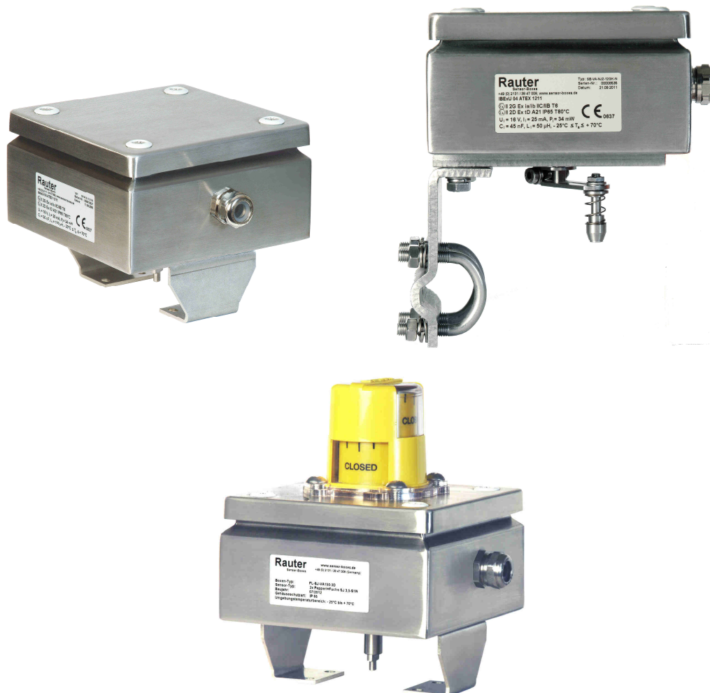
Bild 1-3: links: Edelstahl-Endschalterbox, 1.4301, IP 65, 150x150x80 mm für Drehantriebe nach VDI/VDE 3845 mit Edelstahl-Konsole, rechts: mit Anbausatz für Linearantriebe nach NAMUR IEC 534, unten: mit 3D-Sichtanzeige OPEN/CLOSED für Drehantriebe mit Edelstahl-Konsole
