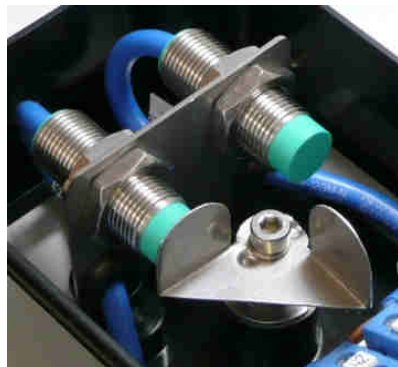
Bild 6+7: links: 2x Pepperl+Fuchs Sensoren NJ2-12GK-N mit Edelstahl-Schaltfahne für Position 0° und 90°, rechts: 2x Pepperl+Fuchs-Sensoren SJ 3,5-S1N für Position 0° und 90° mit 2x variabel einstellbaren Aluminium-Schaltfahnen, welche mit einem Innensechskantschlüssel SW = 2 mm festgezogen werden.
