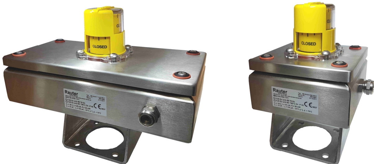
Bild 1+2: Edelstahl-Endschalterboxen, 1.4301, Abm.: 300x150x80mm und 150x150x80mm, Deckel mit 3D-Anzeige OPEN/CLOSED
