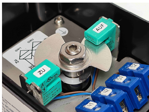
Bild 1+2: Polyamid (Vestamid)-Endschalterbox montiert auf Antrieb, Deckel mit Sichtfenster, Abm. 120x80x55 mm, F05-Aufnahme und Edelstahl-Konsole Abm.: 45/80x30 mm für Antriebe mit 20 mm Wellenüberstand. Innenansicht: 2x eigensichere P+F-Sensoren SJ 3,5-N
