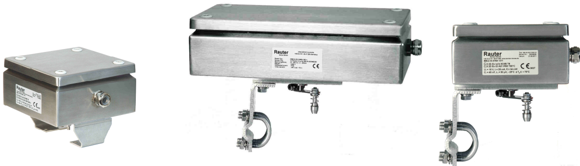
Bild 1-3: links: Edelstahl-Endschalterbox, 1.4301, Abm.: 150x150x80mm, mit Edelstahl-Konsole für Drehantriebe mit Schnittstelle nach VDI/VDE 3845, mitte und rechts: Edelstahl-Endschalterbox, 1.4301, Abm.: 300x150x80mm und Abm.: 150x150x80mm mit Anbausatz für Linearantriebe nach NAMUR IEC 534
