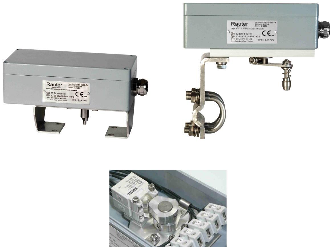
Bild 1-3: Tieftemperatur-Endschalterboxen mit Edelstahl-Konsole und Edelstahl-Anbausatz für Dreh- und Linearantriebe - -55\text{ °C} \leq T_a \leq +70\text{ °C} , Abm.: 175x80x57 mm, IP 65, Innenansicht mit variabel einstellbaren Schaltnocken
