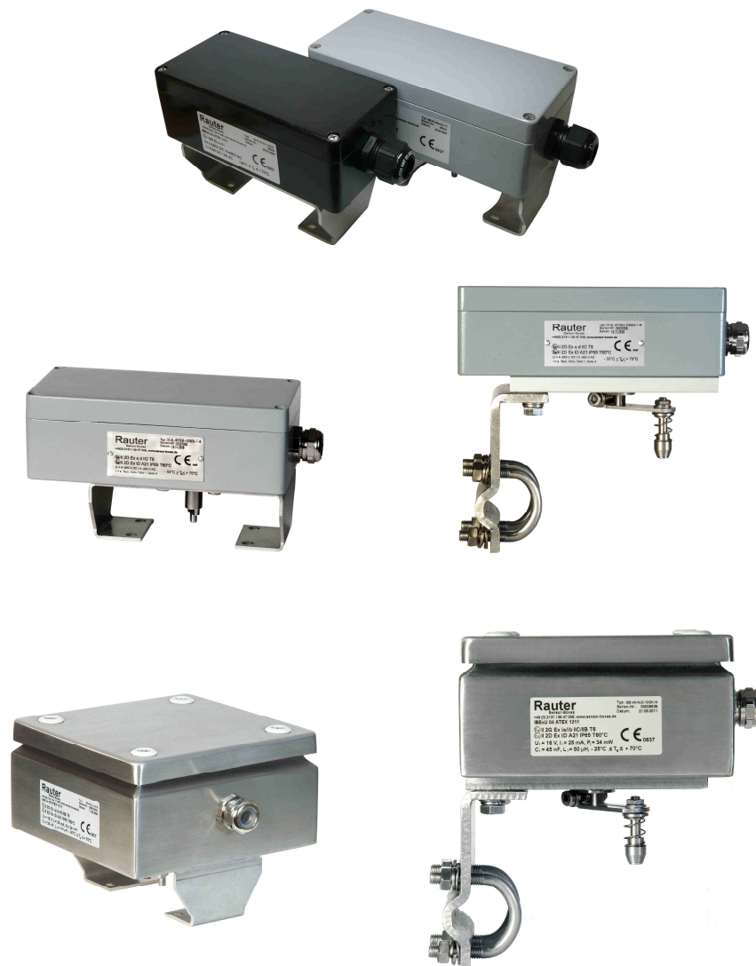
Bild 1-5: Polyester- und Aluminium Endschalterboxen für Drehantriebe, -20^{\circ}\text{C} \leq T_a \leq +70^{\circ}\text{C} , 160x75x55mm/175x80x57mm, Gehäuseschutzart: IP 65, Tieftemperatur-Endschalterbox für Dreh- und Linearantriebe, -55^{\circ}\text{C} \leq T_a \leq +70^{\circ}\text{C} , 175x80x57mm o. 125x80x57mm, Gehäuseschutzart: IP 65, Edelstahl-Endschalterboxen für Dreh- und Linearantriebe, -20^{\circ}\text{C} \leq T_a \leq +70^{\circ}\text{C} , 150x150x80mm, IP 65.
