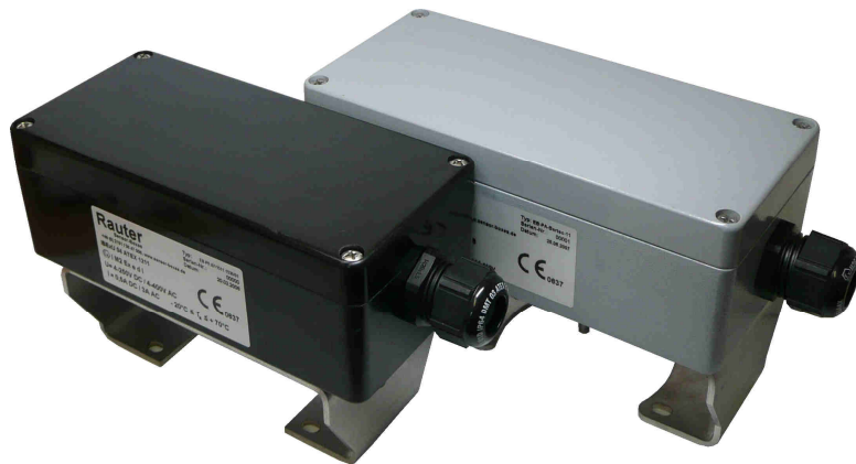
Bild 7: Polyester- und Aluminium-Endschalterboxen für Drehantriebe, -20^{\circ}\text{C} \leq T_a \leq +70^{\circ}\text{C} , 160x75x55mm/175x80x57mm, Gehäuseschutzart: IP 65
