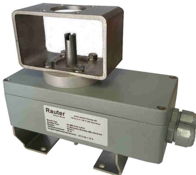
Bild 6: Aluminium-Endschalterbox, Abm.: 175x80x57 mm, Edelstahl-Konsole für Antriebe mit Schnittstelle nach VDI/VDE 3845 und montierter Aufbau-Konsole F05/F05.
