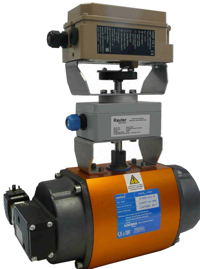
Bild 1: Norbro-Schwenkantrieb mit Aluminium-Endschalterbox,, Abm.: 125x80x57 mm, Edelstahl-Konsole für Antriebe mit Schnittstelle nach VDI/VDE 3845 und montiertem Samson-Stellungsregler.
