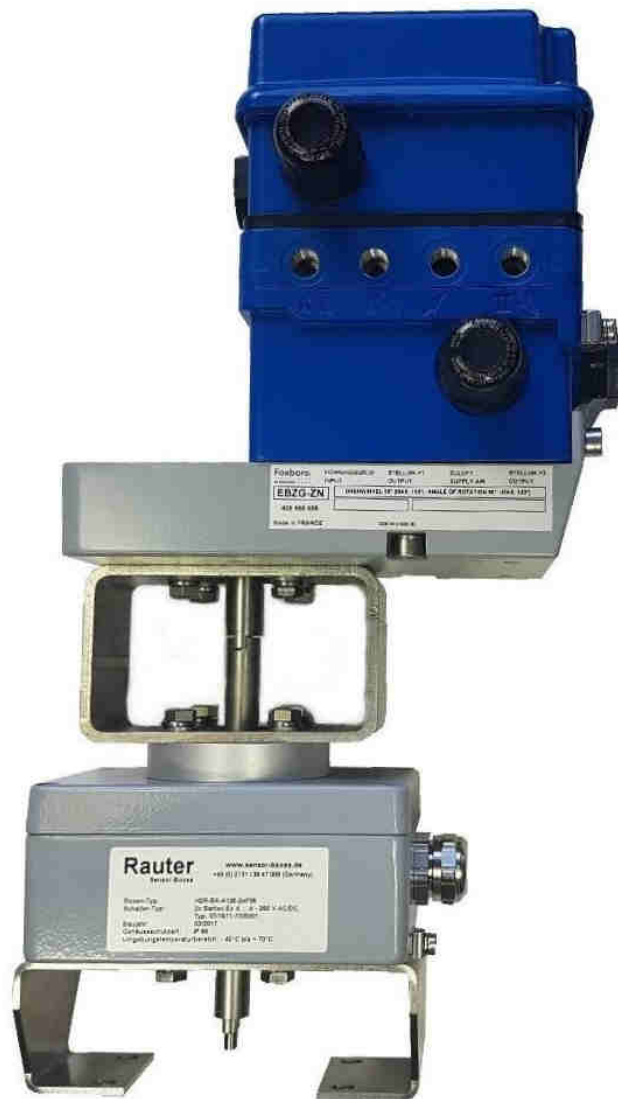
Bild 4: Aluminium-Endschalterbox, Abm.: 125x80x57 mm, F05/F05-Edelstahl-Konsole mit Eckardt-Foxboro-Stellungsregler und Edelstahl-Konsole für Antriebe mit Schnittstelle nach VDI/VDE 3845, Umgebungstemperaturbereich der kpl. Endschalterbox: -40 °C bis +70 °C
