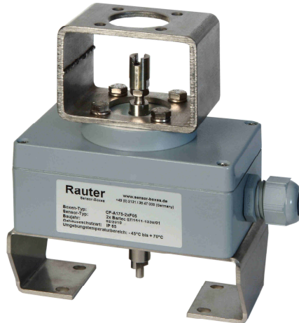
Bild 5: Aluminium-Endschalterbox, Abm.: 125x80x57 mm, Edelstahl-Konsole für Antriebe mit Schnittstelle nach VDI/VDE 3845 und montierter Aufbau-Konsole F05/F05.
