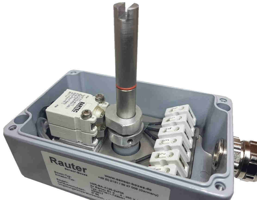
Bild 9: 2x Ex d ... 4 - 250 V AC/DC Bartec-Schalter mit 2x Aluminium-Schaltnocken für beliebig einstellbare Positionen (mit Innensechskantschr. M4 SW 2 mm) und durchgehender Edelstahlwelle zur Direktadaption von Stellungsreglern.
