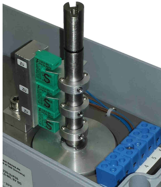
Bild 8: 3x Pepperl+Fuchs Sensoren SJ 3,5-SN für Position Zu mit variabel einstellbaren (mit Innensechskantschr. M4 SW 2 mm) Aluminium-Schaltfahnen und durchgehender Edelstahlwelle zur Direktadaption von Stellungsreglern.
