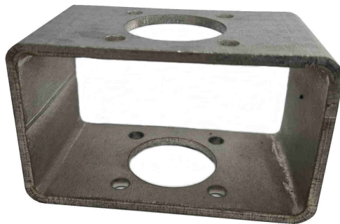
Abb.: Edelstahl-Konsole mit F05/F05-Aufnahme, 50 mm hoch, 100 mm breit, 55 mm tief und 4 mm dick,
