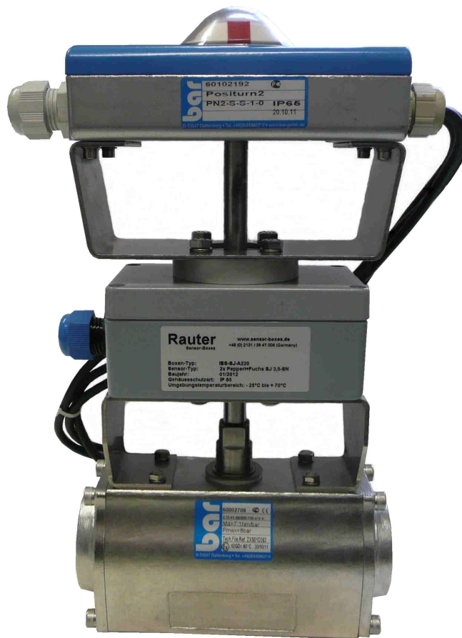
Bild 2: Bar-Schwenkantrieb mit Aluminium-Endschalterbox, Abm.: 125x80x57 mm, Edelstahl-Konsole für Antriebe mit Schnittstelle nach VDI/VDE 3845 und montiertem Bar-Stellungsregler.
