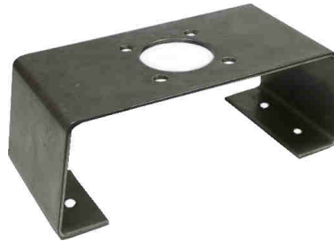
Abb.: Konsole Gr. 3 und 4 für Antriebe nach VDI/VDE 3845 mit 30 und 50mm Wellenüberstand sowie Bohrbild 130x30mm
