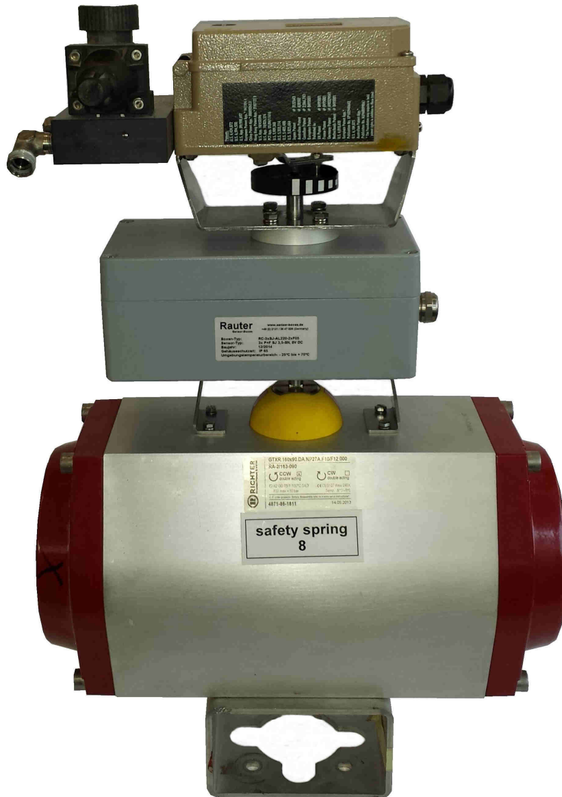
Bild 3: Richter-Schwenkantrieb mit Aluminium-Endschalterbox, Abm.: 220x120x90 mm, Edelstahl-Konsole für Antriebe mit Schnittstelle nach VDI/VDE 3845 und montiertem Samson-Stellungsregler.
