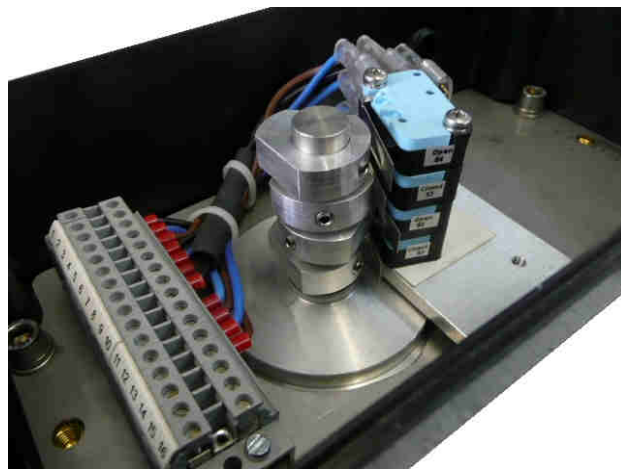
Bild 1+2: links: 6x mechanische 4 - 250 V AC/DC Crouzet-Endschalter für beliebige Positionen S1-S6 , rechts: 4x mechanische 4 - 250 V AC/DC Crouzet-Endschalter für beliebige Positionen S1-S4
