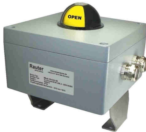
Bild 4: 3D-Aluminium-Endschalterbox, 160x160x90mm für pneumatische Drehantriebe mit Schnittstelle nach VDI/VDE 3845
