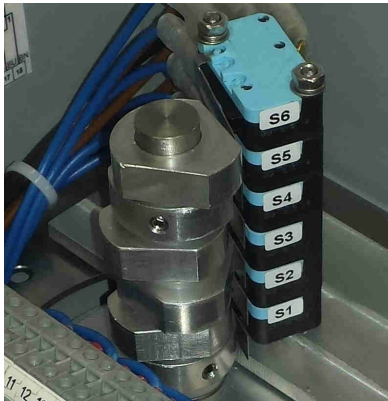
Bild 1+2: links: 6x mechanische 4 - 250 V AC/DC Crouzet-Endschalter für beliebige Positionen S1-S6 , rechts: 4x mechanische 4 - 250 V AC/DC Crouzet-Endschalter für beliebige Positionen S1-S4
