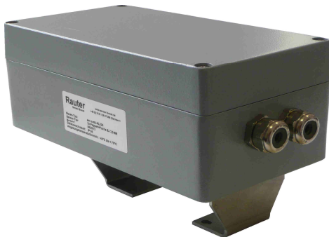
Bild 15+16: Aluminium- und Polyester-Endschalterbox, 220x120x90mm für pneumatische Drehantriebe mit Schnittstelle nach VDI/VDE
