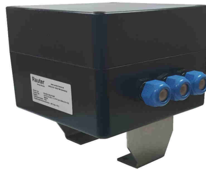
Bild 13+14: Polyester-Endschalterboxen, 160x160x90mm und 160x160x120mm für pneumatische Drehantriebe mit Schnittstelle nach VDI/VDE 3845
