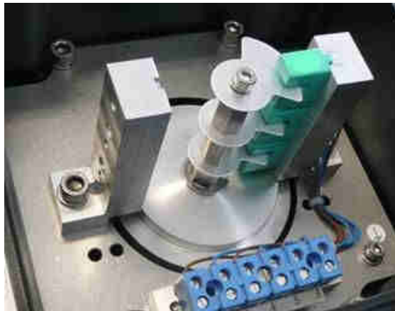
Bild 9: 3x Ex i ... P+F Sensor SJ 3,5-N, 8 V DC für Position AUF
