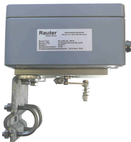
Bild 17+18: Aluminium- und Polyester-Endschalterbox, 160x160x90mm für pneumatische Linearantriebe mit Anbausatz nach NAMUR IEC 534
