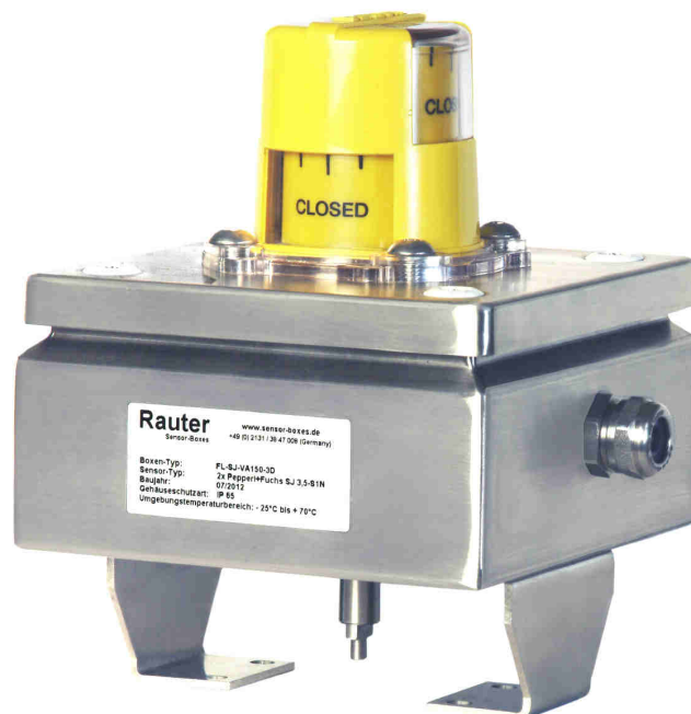
Bild 1: Edelstahl-Endschalterbox mit 3D-Anzeige, Abm.: 150x150x80mm, mit Edelstahlbrücke, 45mm hoch, für Antriebe nach VDI/VDE 3845 mit 20mm Wellenüberstand
