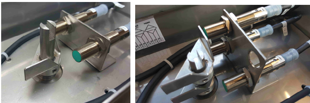
Bild 2+3: induktive Pepperl+Fuchs Sensoren NBB4-12GM45-E2-M für die Positionen (links) 1x OPEN und 1x CLOSED und (rechts) 1x OPEN und 2x CLOSED mit Edelstahl/Aluminium-Schaltfahnen angeschlossen an 6 und 9-polige Klemme
